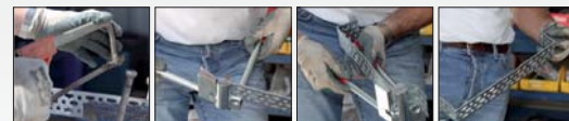
Zaag het profiel op lengte. Buig het profiel op maat (afhankelijk van uw toepassing). Klaar!
